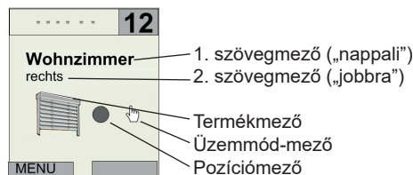
2. ábra Kijelzés üzemmódban (2. példa): 12. csatorna, betanult zsalu, STOP-állapot kézi üzemmód aktív; 1. szövegmező (itt: „nappali”) és 2. szövegmező (itt: „jobbra”) egyéni bevitel
